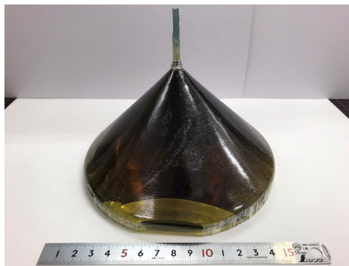
VB法で作製した6インチ単結晶の全体像の写真 ノベルクリスタルテクノロジー社HPより
