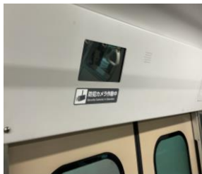
車内防犯カメラ
