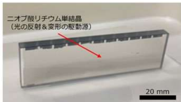
図1 開発が完了した新型形状可変ミラー
