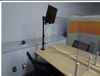
打ち合わせ用ブースに設置されたパーティションおよびCO 2 検知器
