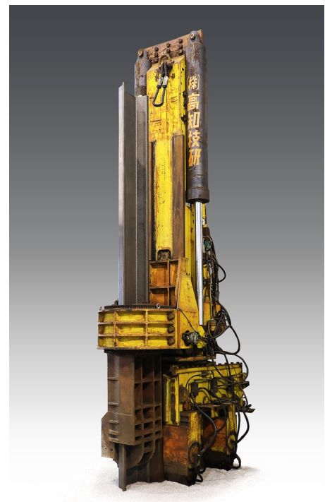
機械遺産に認定された サイレントパイラー ® 1号機 「KGK-100A」
