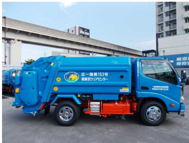
「サステオディーゼル燃料」を使用した食品廃棄物収集専用車
