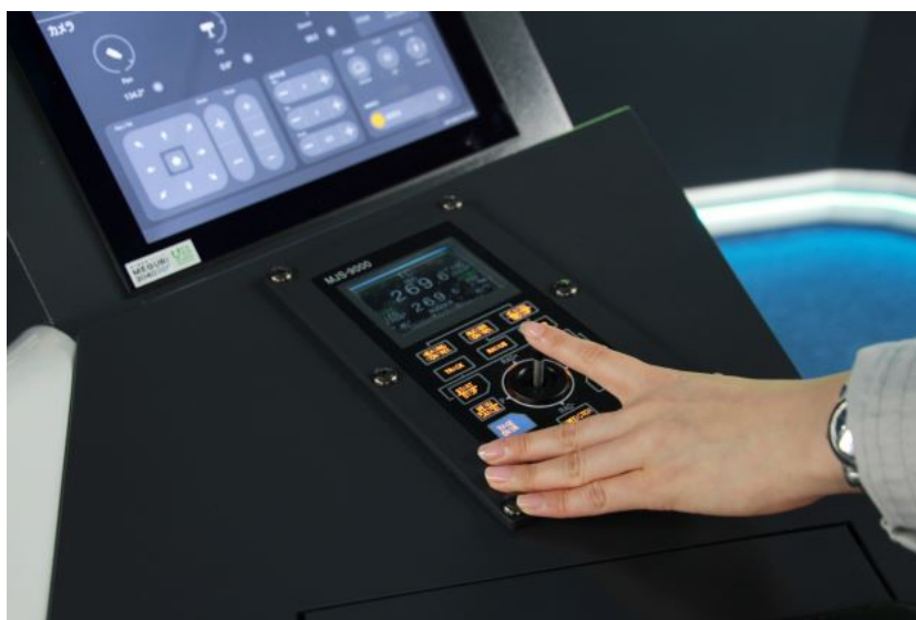
非常対応ブロックに搭載された当社製ジョイスティックコントローラ
