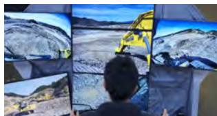
遠隔操作ポッドによる油圧ショベル 「PC200i-11」の遠隔操作(石川県)
