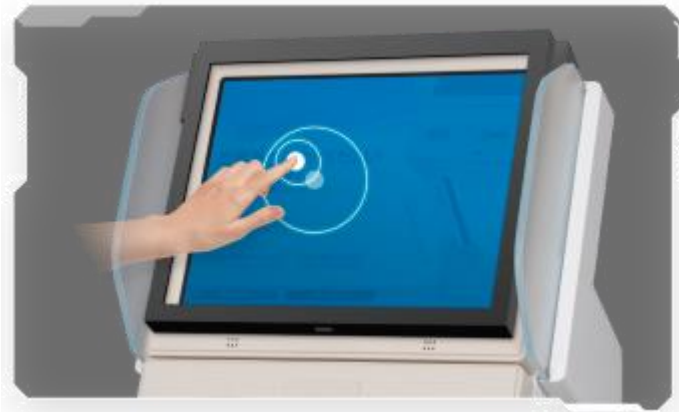
外乱光に強い赤外線イメージセンサー搭載
