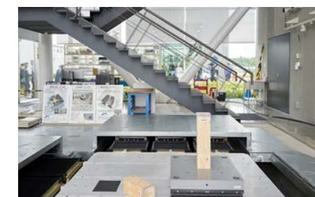
「つくば未来センター」の免震技術試験設備
