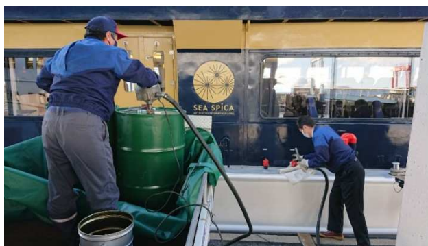
サステオ給油の様子
