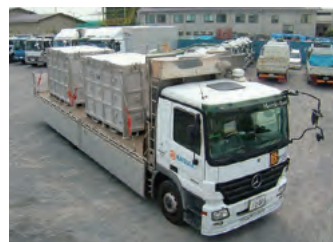
PCB廃棄物専用運搬車両
