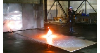
④直接つけても 着火燃焼を抑制
