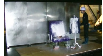
④直接つけても 着火燃焼を抑制
