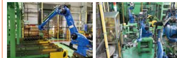
ロボットによる自動搬送や通電式焼熱処理により省人・省エネを実現 (ばね)
