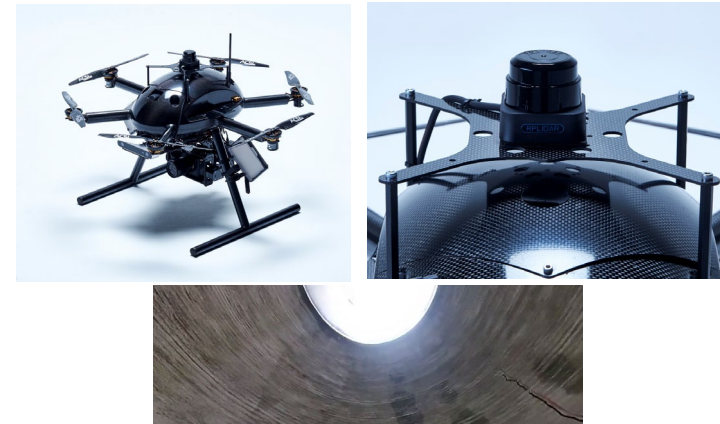
左上: 煙突点検用ドローン (ACSL-PF2)
