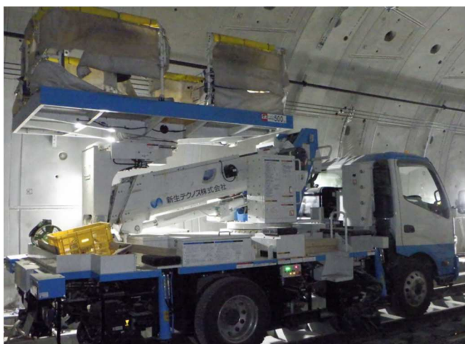
<レール上を走行できる工事車両>
