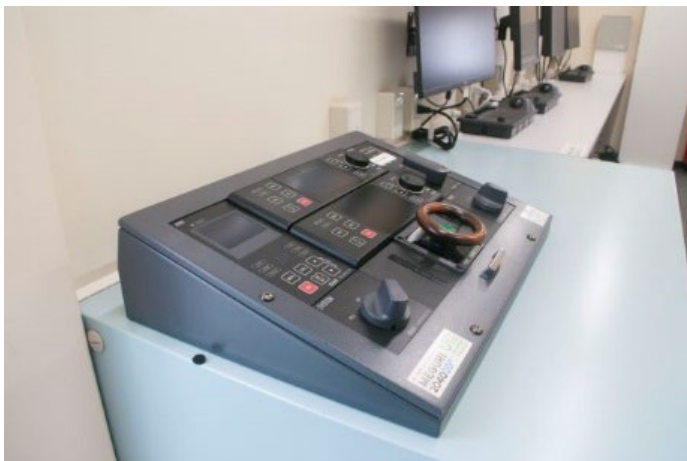
DFFAS システムに搭載されたオートパイロット PR-9000
