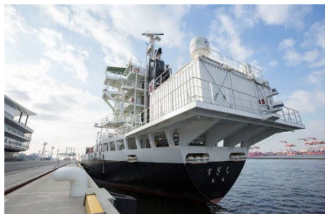
実証実験に使用された貨物船「すぎく」 DFFAS システムは後部デッキのコンテナに収納されている。
