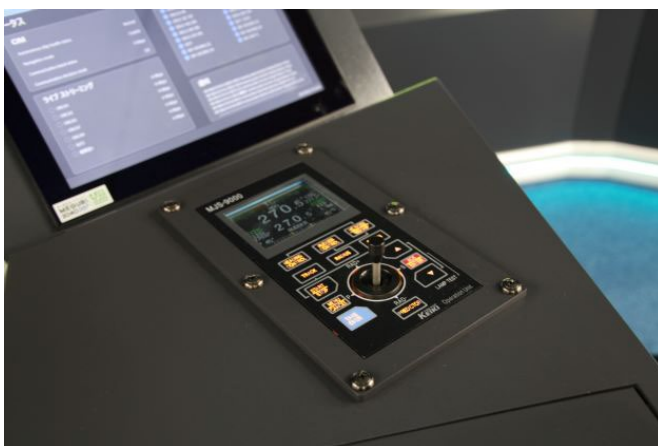
陸上支援センターの非常対応ブロックに搭載された多機能型ジョイスティックコントローラ MJS-9000
