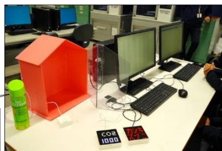
住宅型の密閉模型を使用して CO 2 濃度の検知をおこなっている様子
