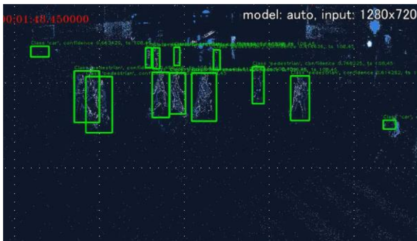
写真3) EVS(イベントベースセンサー)カメラ映像(HD): 駅構内の人物もサチレーションは発生せず AI 検知可能
