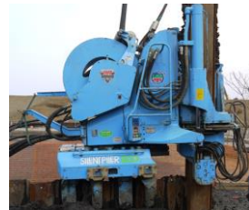
サイレントパイラー工法
