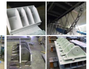
落橋防止金物
