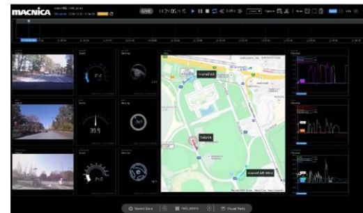
自動運転バスの遠隔監視と モビリティの群管理システム
