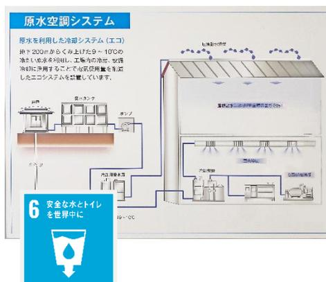
富士吉田工場では、地下水200mからくみ上げた9度～10度の冷たい原水を利用し、工場内の冷房・設備冷却に活用することで電気使用料を削減したエコシステムを設置しています。
