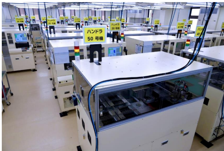
大型の自動プログラミングシステム（ハンドラ）を大規模増設した MAT クリーンルーム
