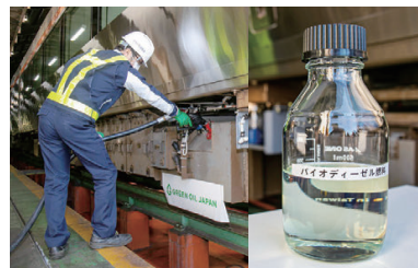
HC85系試験走行車における バイオディーゼル燃料の試験
