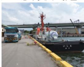
LNG燃料タグポート「いしん」へのCNLNG供給の様子
