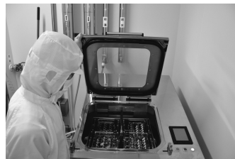
打錠機の杵は全て取り外し、1本1本洗浄
