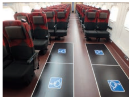
北陸新幹線E7系の車いす用フリースペース(一部列車で設置)
