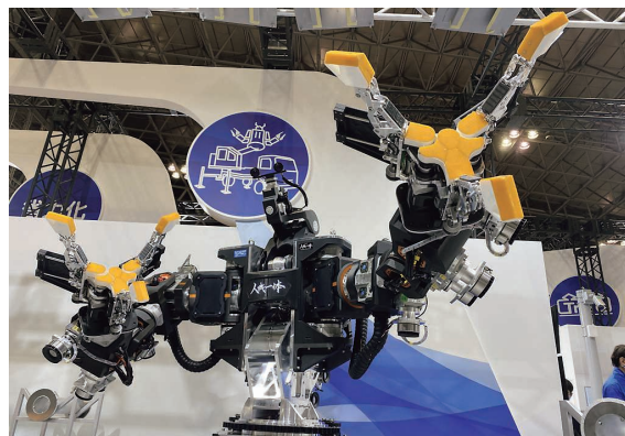
人機一体社が開発中の人型重機試作機（零式人機 ver1.1）
