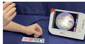
OKファイバーテクノロジー社が開発中の医療用複合型光ファイバコープ（左）とポータブル内視鏡（右）
