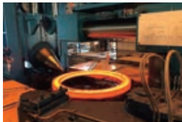
風力発電用設備(リング鍛造品)の製造工程(ブラジル)
