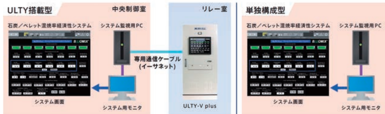
バイオマス燃料混焼率最適化システム
