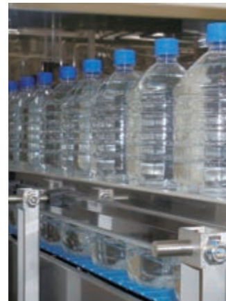
大型ペットボトルの無菌充填ライン
