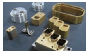
飲料用アルミ蓋製造ラインで使用する精密金型
