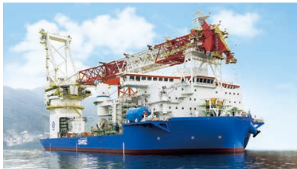
建造中の自航式SEP船 (Self-Elevating Platform: 自己昇降式作業船)
