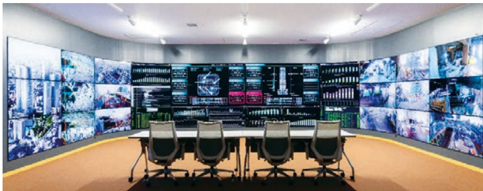
統合監視室ではタワークレーン、工用エレベーターの稼働状況などを具体的なデータと映像でリアルタイムに監視が可能
