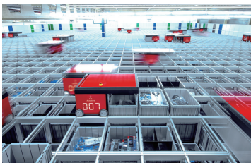
ロボットストレージシステム
