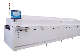
リフローはんだ付装置
