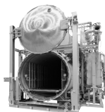
熱水スプレー式滅菌装置 (GPS：高温高压医薬滅菌装置)
