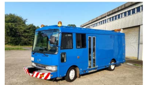
（国研）土木研究所が所有する移動式たわみ測定装置（MWD）
