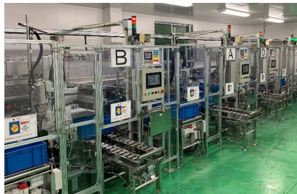
ロボットによる自動コンテナ詰機
