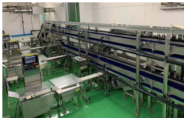
自動冷却搬送ライン設備
