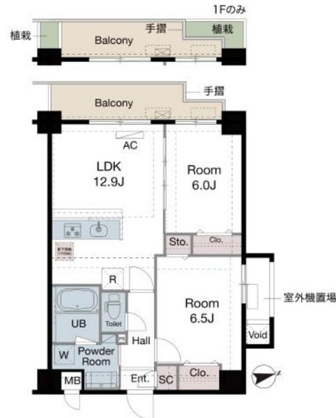
■ 収納 ■ 水まわり ■ AC ■ エアコン室内機 ■ エアコン室外機 ■ RC壁 ■ 乾式間仕切
