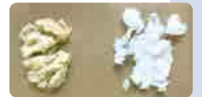
オゾン処理前(左)とオゾン処理後(右)のパルプ比較
