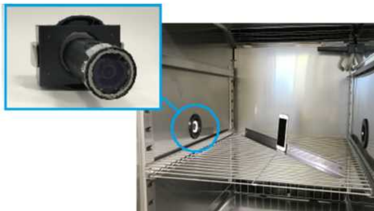
槽内監視カメライメージ
