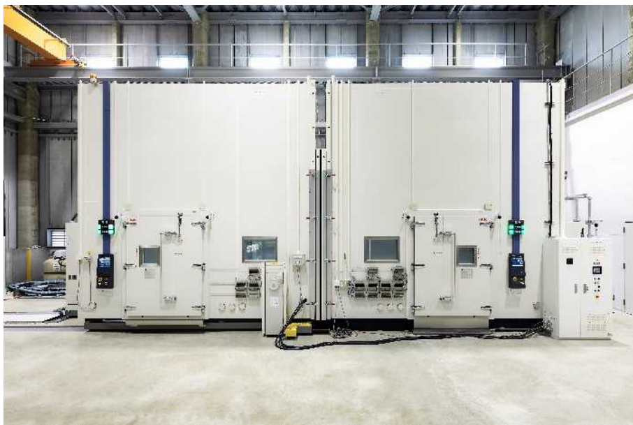
恒温(恒湿)室 建材用試験室
