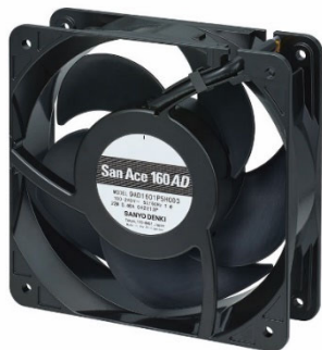
9ADタイプ (リード線仕様, PWMコントロール・パルスセンサ付)
