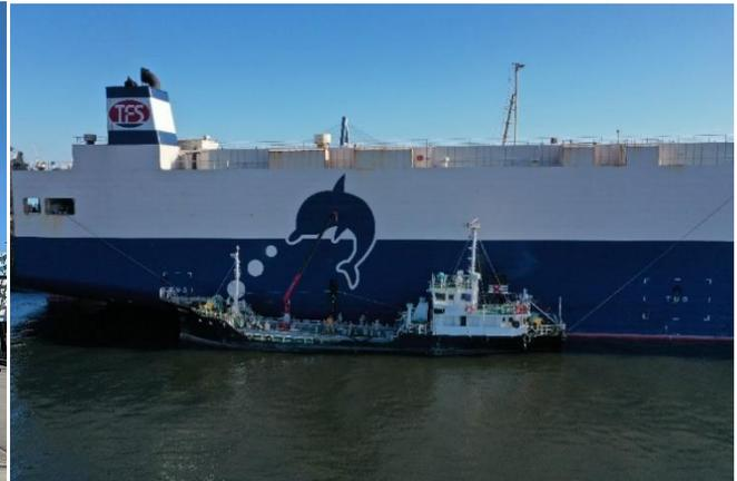
左からバイオ燃料の供給を受ける自動車運搬船「とよふじ丸」(トヨフジ海運)と供給を行う燃料供給船「尚山」(豊田通商)
