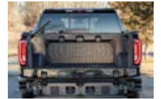
米国のGeneral Motorsのピックアップトラックに採用された、帝人の熱可塑性炭素繊維複合材料「Sereebo」
