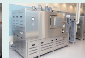
促進防錆試験室
