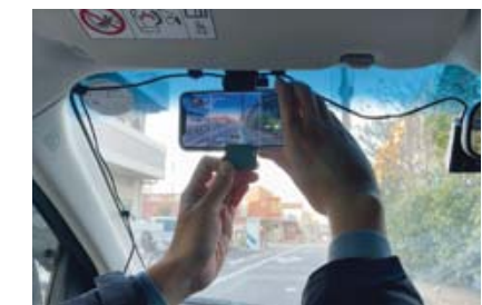
GLOCAL-EYEZ (スマートフォンによる道路点検システム)
