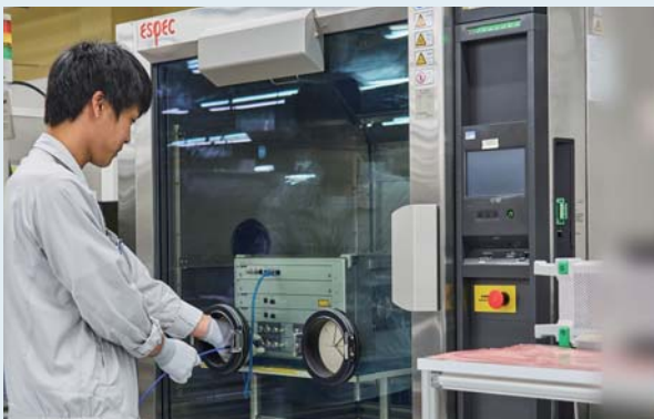
試験槽内が見えるワイドビュー扉の恒温器プラチナスJシリーズ 操作孔から手を入れてケーブルのつなぎ替えなどの作業ができる
