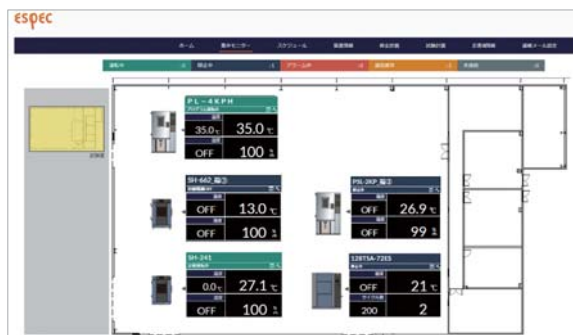
集中モニター画面 遠隔地から試験器の運転状況を確認
