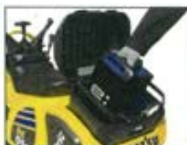
【左：電動マイクロショベル PC01E-1 右：Honda Mobile Power Pack e:】
