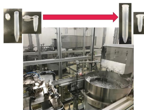
【チューブの自動蓋閉めロボット】 社員は1日2,000本の蓋閉めという単純作業から解放されました。
