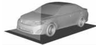
衝突時の車体に加わる力を解析
