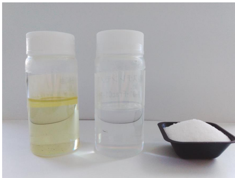
図3 小型実証機を用いてケミカルリサイクルした再生ポリスチレン (左:分解オイル/中:回収スチレンモノマー/右:再生ポリスチレン)
